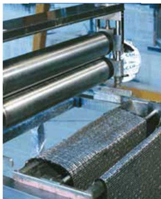
Postupak potapanja tkanine ručno i strojno
