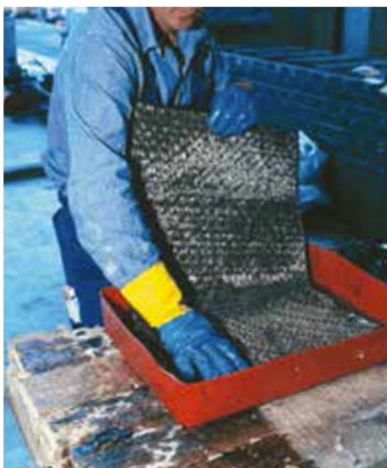
Postupak potapanja tkanine ručno i strojno
