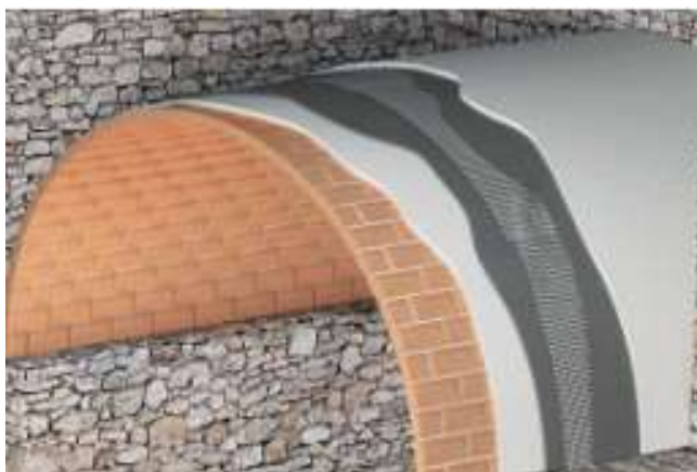
Prikaz postupka izvedbe FRCM-a na svodovima
