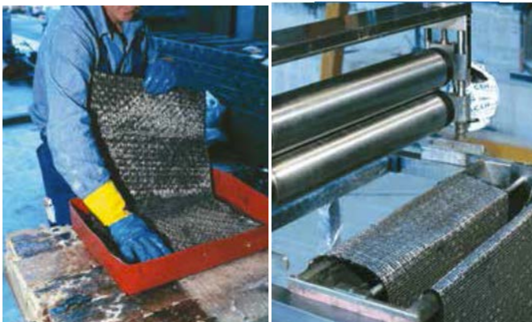
Postupak potapanja tkanine ručno i strojno
