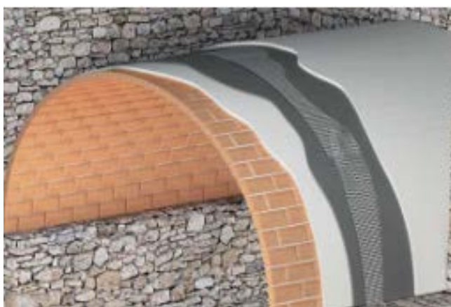
Prikaz postupka izvedbe FRCM-a na svodovima
