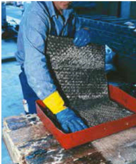
Postupak potapanja tkanine ručno i strojno
